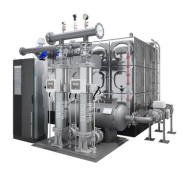
箱式供水设备这种加压稳定设备为解决临时高压消防供水系统在系统的缺点是水压时不能满足设置加压设施的要求而设置的高层消防水箱。. 箱式供水设备该设备适用于多层和高层建筑工程中的消火栓供水系统和湿式自动喷水灭火系统以及其他加压设施所需的消防供水和生活供水系统箱式供水设备的"设备"由隔膜压力罐、水泵、电控箱、仪表、管道附件等组成。五箱无负压供水设备,该设备符合《民用建筑设计民用消防标准》(以下简称《高标准[])GB50045-95和《气动供水设计标准[][]CEC76:95[]的相关技术参数设计。箱式非负压供水设备的选择是基于一套恒压供水设备的选择,基本依据是供水流量和供水压力(水头)的设计,此外还需要考虑流量变化类型的使用。箱式供水设备的连续型:很少在内流量为零,或者正常泄漏时,自己的管网保持一定流量,例如大型酒店、酒店、工矿企业等加压系统。
