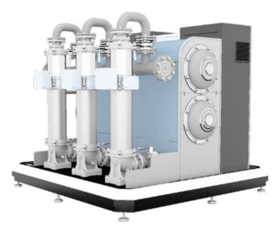
无负压的供水是什么?它的原理和优缺点是什么?当自来水压力低于用户要求时,控制系统将自动控制变频器软件开始运行,直到用户管网的实际工作压力等于设定压力。变频器控制变频器泵以恒定速度运行。自来水压力越高,变频器泵的速度越低。水压越低,变频泵的速度越高。当自来水压力等于设定压力时,变频泵会延迟休眠,也就是说,它会充分利用自来水的原始压力,确保用户所需的压力恒定。当压力降至唤醒值时,泵会自行唤醒。变频器泵的进气口与不锈钢稳流补偿器连接。计算机系统检测稳流补偿器中的压力。通过进水压力检测和真空自动器来确保稳流补偿器中的负压,从而确保供水网络的正常供水。二次给水设备质量有保证。江苏变频供水设备代理
