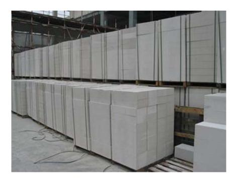
1、首先来告诉大家,加气砖储存和供料原材料均由汽车运入厂内,粉煤灰在原材料场集中,使用时用装运入料加气块制品制作的五大流程。2、加气块原材料,使用球磨机来处理粉煤灰经电磁振动给料机、胶带输送机送入球磨机,磨细后的粉灰用粉煤灰泵分别送至料浆罐储存。3、化学品按一定比例经人工计量后,制成一定浓度的溶液,送入储罐内储存。铝粉由铝粉库运至生产车间,用电葫芦提升到配料楼二楼倒入搅拌机中定量加水,搅拌成铝粉悬浮液加气块配料、搅拌、浇注石灰、水泥由粉料配料仓下的螺旋输送机依次送到自动计量秤累积计量,秤下有螺旋输送机可将物料均匀加入浇注搅拌机内。4、加气砖初养和切割浇注后模具用输送链推入初养室进行发气初凝,室温为48~68℃,初养时间为,初养后用负压吊具将模框及坯体一同吊到预先放好釜底板的切割台上. 脱去模框. 切割时产生的坯体边角废料,经螺旋输送机送到切割机旁的废浆搅袢机中,加水制成废料浆,待配料时使用。5、加气块蒸压及成品坯体在釜前停车线上编组完成后,打开要出釜的蒸压釜釜门,先用卷扬机拉出釜内的成品釜车,然后再将准备蒸压的釜车用卷扬机拉入蒸压釜进行养护。
